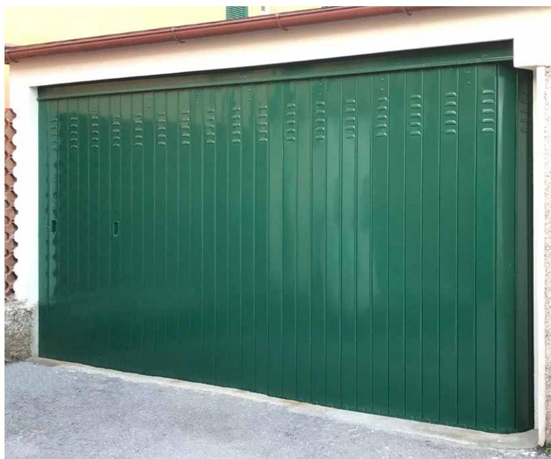
Costruito con elementi verticali zincati con spessore da 8/10 e 10/10 a seconda delle dimensioni. Lo scorrimento è su ruote superiori o inferiori, ad una o due partite. A richiesta può essere costruito con elementi forati per l'aerazione. Può essere fornito zincato o verniciato a polveri con essiccazione oltre 180° C.
